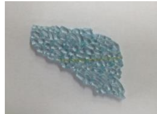
③剥離処理あと(熱線・糊剥離)
