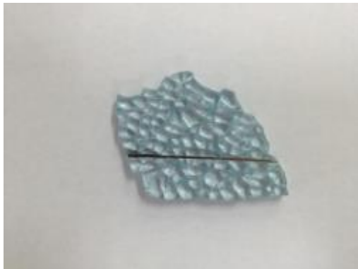
①剥離処理まえ(熱線有)
